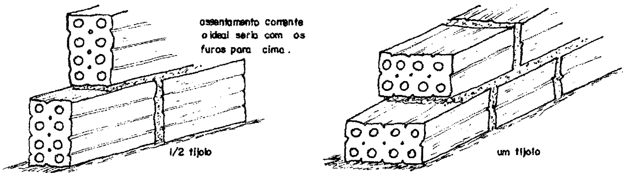
Figura 1 - Execução de alvenaria utilizando tijolos furados.
